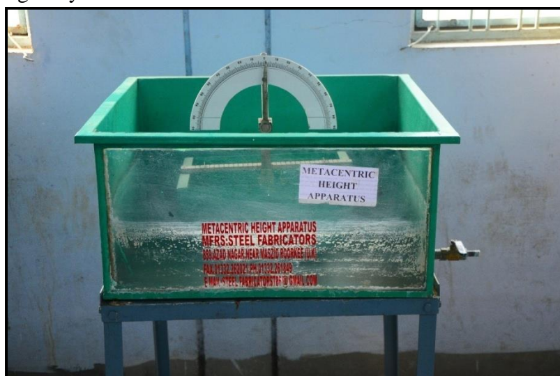
Metacentric Height Apparatus
